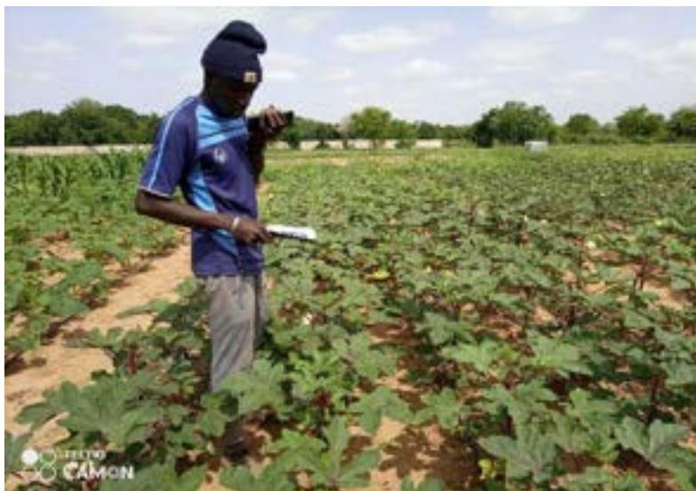
Photo 27 : Mesure de la vigueur à l'aide du GREENSEEKER
