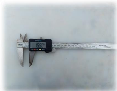
| Photo 3 : Pied à coulisse électronique
